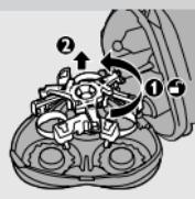
**1** Ouvrez l'unité de rasage, faites tourner le système de fixation dans le sens inverse des aiguilles d'une montre (1), puis retirez-le (2).
