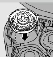
**4** Entnehmen Sie die Scherköpfe, und setzen Sie neue Scherköpfe in die Schereinheit ein. Setzen Sie den Scherkopfhalter wieder in die Schereinheit, und drehen Sie die Verriegelung im Uhrzeigersinn fest.
