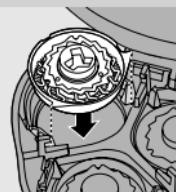
Asegúrese de que los salientes de los cabezales de afeitado encajan exactamente en las ranuras.
