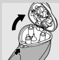
**1** Desligue a máquina de barbear, retire a ficha de alimentação da tomada eléctrica e puxe a ficha do aparelho para fora da máquina.
