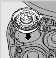
**4** Retire as cabeças e coloque as cabeças novas na unidade de corte. Volte a colocar a armação de fixação na unidade de corte e rode o bloqueio para a direita.
