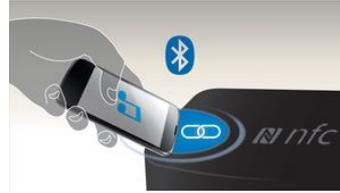
Verbinde Bluetooth-Geräte mit der One-Touch-NFC-Technologie (Near Field Communications) durch eine einfache Berührung. Berühre das NFC-fähige Smartphone oder Tablet im NFC-Bereich eines Lautsprechers, um den Lautsprecher einzuschalten, die Bluetooth-Kopplung zu starten und mit der Musikübertragung zu beginnen.
