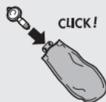
۴ کارتريج را همراه با پمپ به درون ماشين اصلاح فشار دهيد. کارتريج فقط هنگامي در جاي خود قرار مي گيرد كه قسمت سفيد پمپ بطرف بالا باشد. پوشش را ببنديد.
