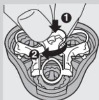
**5** Coloque de nuevo el marco de retención en la unidad de afeitado, presione la rueda (1) y gírela en el sentido de las agujas del reloj (2).
