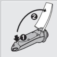
**1** Appuyez sur le bouton de déverrouillage (1) et ouvrez le couvercle du compartiment à cartouche (2).
