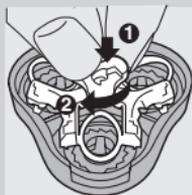
**5** Remplacez le système de fixation dans l'unité de rasage, appuyez sur la molette (1) puis faites-la tourner dans le sens des aiguilles d'une montre (2).
