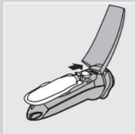
**3** Empurre a bomba para dentro da nova recarga até se fixar na posição correcta com um clique. Feche a tampa.
