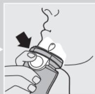
۳ کارتريج را همراه با پمپ به درون ماشين اصلاح فشار دهيد. کارتريج فقط هنگامي در جاي خود قرار مي گيرد كه قسمت سفيد پمپ بطرف بالا باشد.
