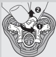
**3** Rode o anel para a esquerda (1) e retire a armação de fixação (2).
