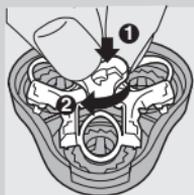
**5** Reponha a armação de fixação na unidade de corte, prima o anel (1) e rode-o para a direita (2).
