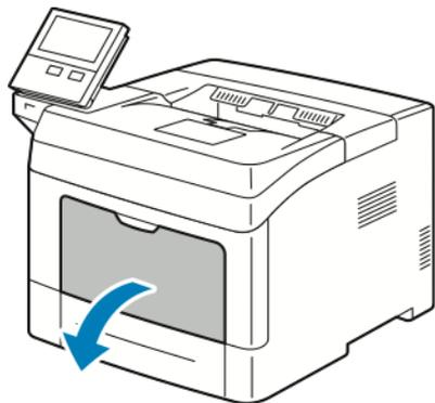
2. Per rimuovere il vassoio bypass dalla stampante, estrarlo completamente dalla macchina.
