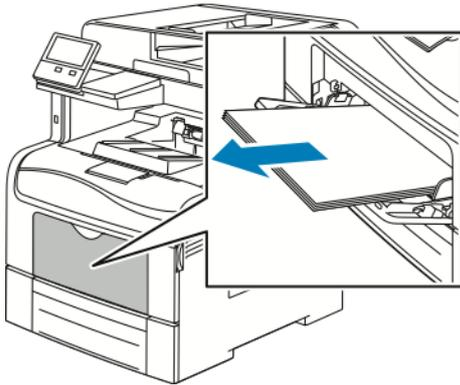
2. Die Zusatzzufuhr an beiden Seiten anfassen und gerade aus dem Drucker herausziehen.
