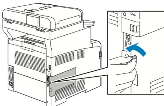
3. Zum Öffnen der Abdeckung diese zur Rückseite hin aus dem Drucker herauschieben.
