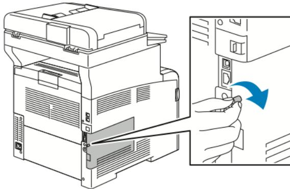
8. Drucker mit einem USB-Kabel direkt oder mit einem Ethernet-Kabel über das Netzwerk mit dem Computer verbinden.
