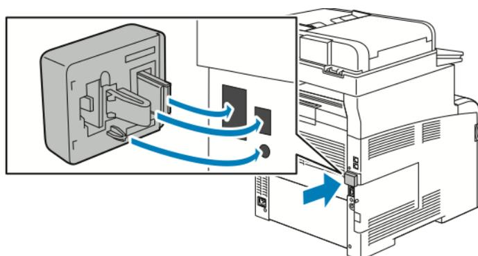
**!** **Achtung:** Wenn am Adapter gezogen wird, kann dieser beschädigt werden. Nach der Installation den Adapter nur dann entfernen, wenn dies erforderlich ist. Dabei die Ausbauanweisungen beachten. Weitere Informationen siehe [Entfernen des WLAN-Adapters](#).
