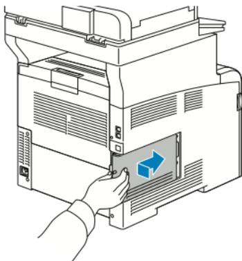
7. Zum Befestigen der Abdeckung die Schraube nach rechts drehen.
