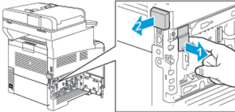
**!** **Achtung:** WLAN-Adapter nicht mit Gewalt herausziehen. Wenn die Verriegelung richtig gelöst ist, lässt sich der Adapter leicht herausziehen. Ist dies nicht der Fall, kann der Adapter beim Herausziehen beschädigt werden.
