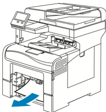
6. Zerknittertes Material aus dem Behälter und ggf. verbliebenes gestautes Material aus dem Drucker entfernen.
