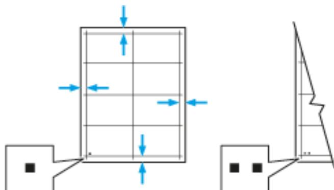
10. Für die Rückseite mit einem Lineal den Abstand des Druckbilds von der oberen, unteren, linken und rechten Kante messen.
