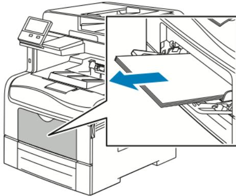
2. Etiketten so in die Zusatzzufuhr einlegen, dass die Vorderseite nach oben und die Oberkante des Bogens zum Einzug weist.
