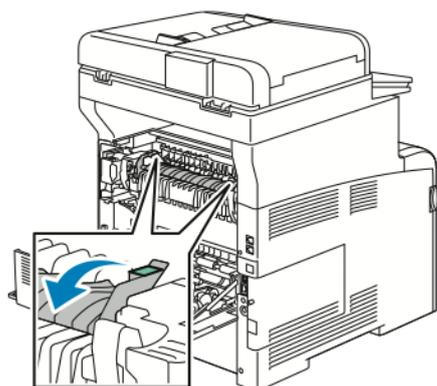
4. Gestautes Material an der Rückseite des Druckers entfernen.
