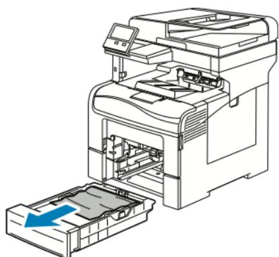
7. Behälter 1 in den Drucker einsetzen und ganz einschieben.
