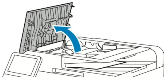
2. Bei einem Materialstau im automatischen Duplex-Vorlageneinzug die Vorlagenabdeckung öffnen und gestautes Material entfernen.
