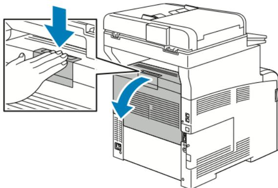
2. Wenn Material in der Fixieranlage gestaut ist, die beiden grünen Hebel aufrichten, um die Fixieranlage zu öffnen.
