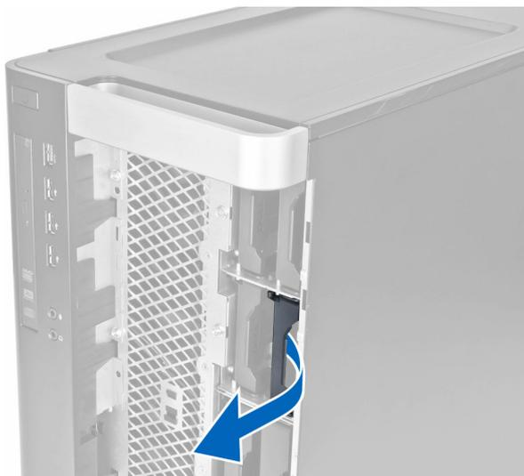
6. Deslice el segundo soporte de la unidad de disco duro en dirección hacia afuera para extraerla del equipo.
