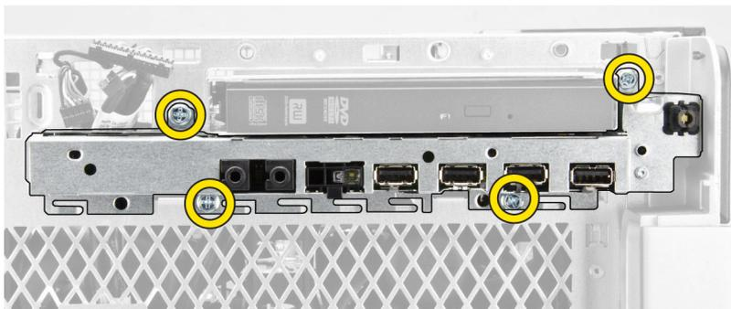
5. Tire del ensamblaje del panel de E/S en dirección opuesta al equipo para liberar sus bordes de los sujetadores del chasis.
