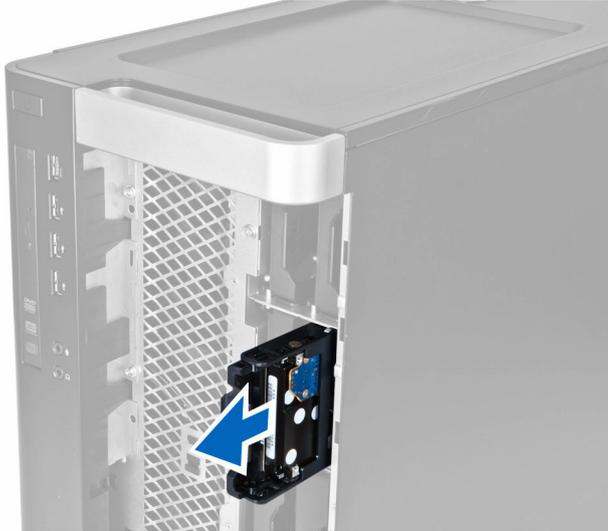
7. Doble el soporte de la unidad de disco duro a ambos lados para aflojar la unidad.
