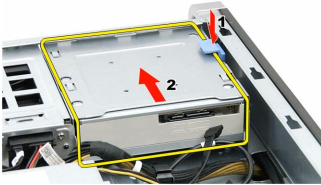
5. Extraiga los tornillos de la unidad óptica y retire el soporte.
