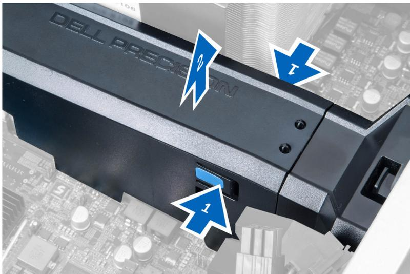
4. Presione el pestillo de liberación al otro lado del módulo de la cubierta de la memoria para liberarlo de chasis.
