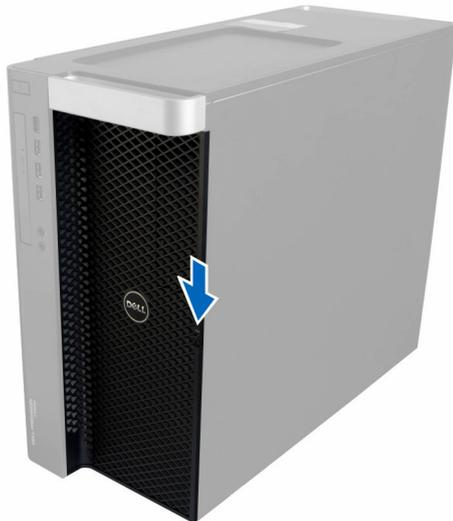
3. Mantenga presionado el pestillo y tire de la cubierta frontal hacia afuera para extraerla del equipo.
