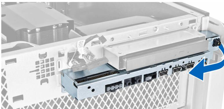
6. Deslice hacia afuera el borde opuesto del ensamblaje del panel de E/S para desenganchar el ensamblaje de E/S del chasis.
