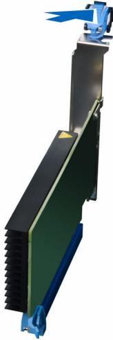
4. Presione el pestillo y saque la tarjeta PCI del equipo.
