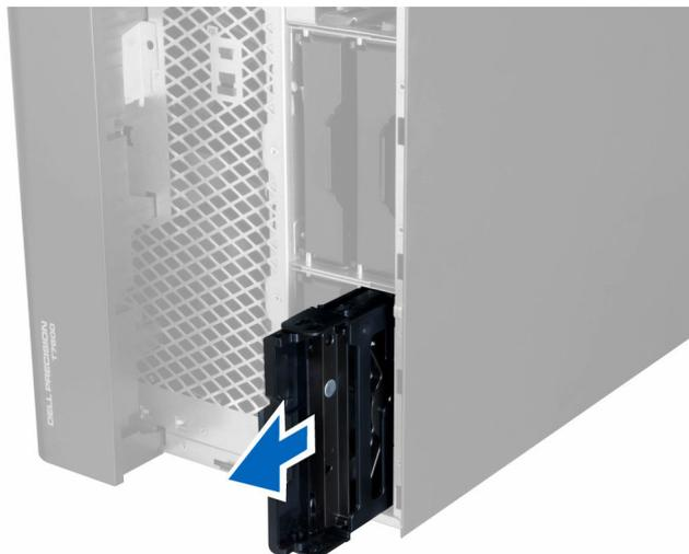
5. Si hay una segunda unidad de disco duro instalada, tire el cierre del segundo soporte de la unidad de disco duro hacia afuera.
