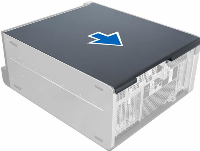
4. Levante la cubierta derecha hacia arriba a un ángulo de 45 grados y retírela del equipo.
