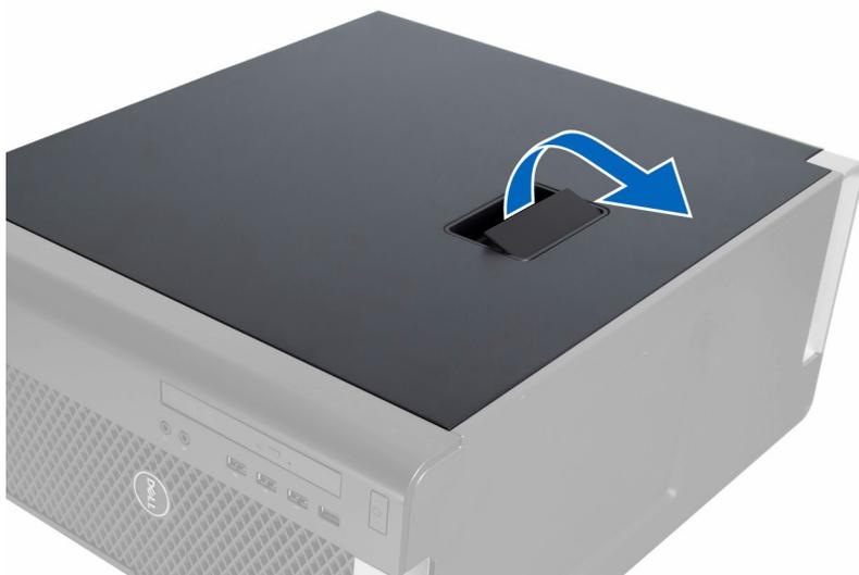
3. Levante la cubierta hacia arriba con un ángulo de 45 grados y retírela del equipo.
