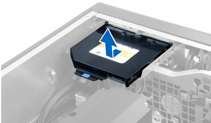
7. Doble el soporte de la unidad óptica en dirección hacia afuera para aflojar la unidad de su soporte.
