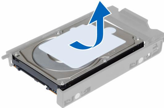
9. Si una unidad de disco duro de 2.5 pulgadas está instalada, empuje los sujetadores de retención en dirección hacia arriba y levante la unidad para extraerla del caddy de la unidad de disco duro de 3.5 pulgadas.
