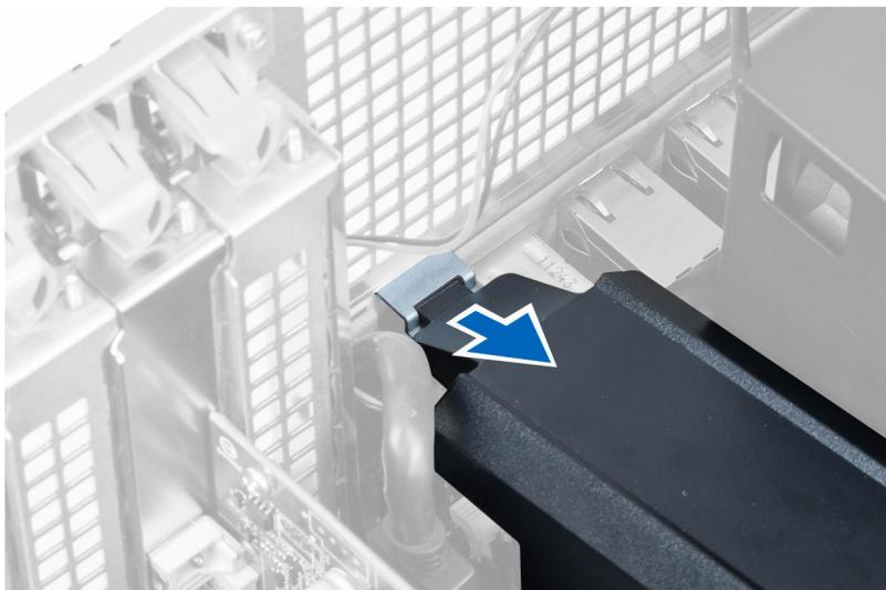
5. Presione el pestillo de liberación en la base de la cubierta de la memoria y levántelo para extraerlo del equipo.
