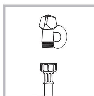
1. Conectar el tubo de tubo enroscándolo a un grifo de agua fría con la boca roscada de 3/4 gas (*ver la figura*). Antes de conectarlo, haga correr el agua hasta que esté limpia.
