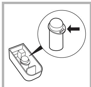
Al verter el blanqueador no debe superar el nivel "máx." indicado en el perno central (véase la figura).
