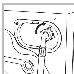
2. Podłączyć do maszyny przewód doprowadzający wodę, przykręcając go do odpowiedniego otworu dopływowego, znajdującego się w tylnej części pralki, z prawej strony u góry (patrz rysunek).
