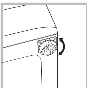
2. Jeśli podłoga nie jest idealnie pozioma, należy skompensować n i e r ó w n o s c i , o d k rę c a j ą c l u b dokręcając przednie nóżki (patrz rysunek);
