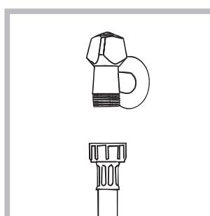
1. Podłączyć przewód zasilający poprzez przykręcenie do zaworu wody zimnej z końcówką gwintowaną  $\frac{3}{4}$  gas (patrz rysunek). Przed podłączeniem spuszczać wodę do momentu, aż stanie się ona całkowicie przezroczysta.
