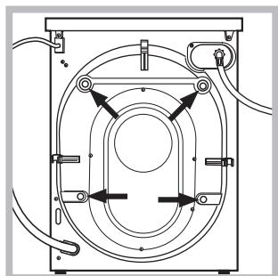
3. Scoateți cele 4 șuruburi de protecție pentru transport și cauciucul cu respectivul distanțier, situate în partea posterioară (a se vedea figura).
