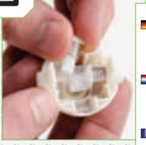
■ Nehmen Sie die Halter mit den Federn heraus. Sie können jetzt die Federn austauschen. Nehmen Sie die Federn aus den Haltern und setzen Sie die anderen mitgelieferten Federn ein.
