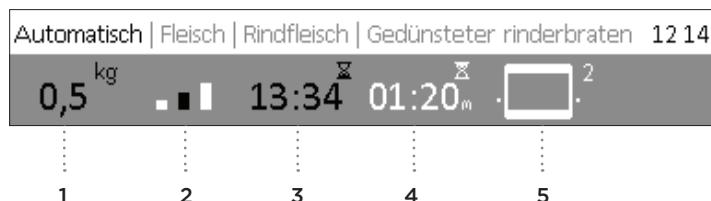
Auf dem Display erscheinen voreingestellte Werte, die Sie durch Drehen des KNEBELS und Bestätigung durch Drücken des KNEBELS selbst ändern können.
