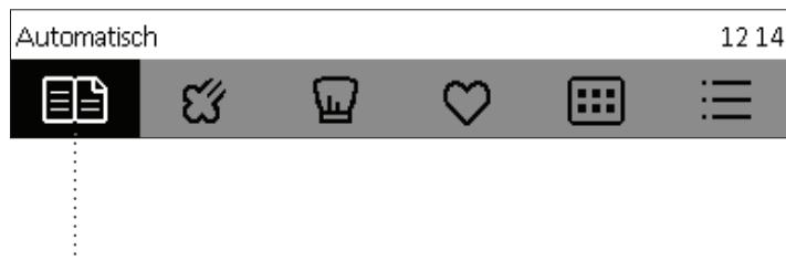
Drehen Sie den Knebel und wählen Sie die Betriebsart AUTOMATISCH aus. Bestätigen Sie die Einstellung durch Drücken des KNEBELS.
