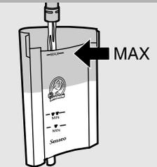
Regelmatig ontkalken verlengt de levensduur van de machine en garandeert langdurig een optimaal resultaat. Bij een gemiddeld gebruik van 2 keer per dag, dient u de machine eens in de 3 maanden te ontkalken
