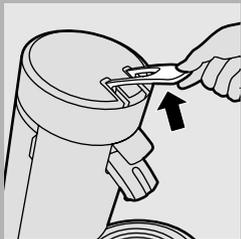
**3** Klappen Sie den Verschlusshebel nach oben, um den Deckel zu öffnen.
