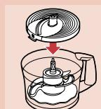
► Установите насадки (диск для перемешивания жидкостей, нож, насадку для замешивания теста и рамку для ножей-вставок) на держатель для насадок и храните их в чаше. Последней всегда устанавливайте рамку для ножей-вставок.
