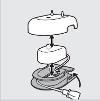
고급 충전기 덮개 및 받침대가 모델에 포함되어 있다면 덮개 내부에 여행용 충전기가 내장되어 있습니다. 전원 코드를 짧게 하려면 충전대에 내장 되어있는 코드 정리 기능을 이용해 사용하지 않는 코드를 보관할 수 있습니다.
