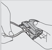
**3** 当储藏了多余的电源线时，可通过灰色充电座后面的小槽导出电源线。
