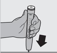
**3** 將握把上下顛倒握住，將主軸往下壓，使握把的內部零件鬆脫。
