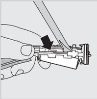
**4** 將螺絲起子插入電池連接線旁邊的電路板下方，以扭轉方式斷開連接線。取出電路板，再將電池從塑膠固定座撬開。
