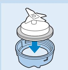
**3** Aperte a interface da lâmina que se encontra na parte inferior do copo misturador até ficar devidamente presa.
