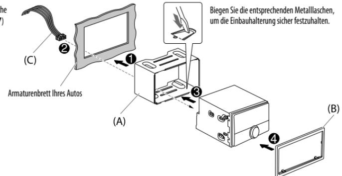
Biegen Sie die entsprechenden Metalllaschen, um die Einbauhalterung sicher festzuhalten.
