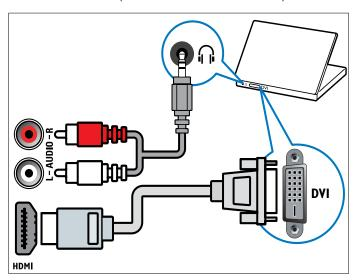
Cavo HDMI e adattatore HDMI-DVI (HDMI posteriore e AUDIO IN)
