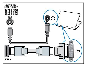
Cavo HDMI e adattatore HDMI-DVI (HDMI laterale e AUDIO IN L/R)
