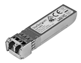
Das AJ716BST ist ein HPE AJ716B-kompatibles Glasfaser-Transceiver-Modul, das speziell für die Zusammenarbeit mit HPE®-Switches und -Router entwickelt, programmiert und getestet wurde. Es liefert zuverlässige 8-GbE-Konnektivität über Glasfaserkabel für 8GFC-konforme Netzwerke mit einer maximalen Entfernung von bis zu 300 m.
