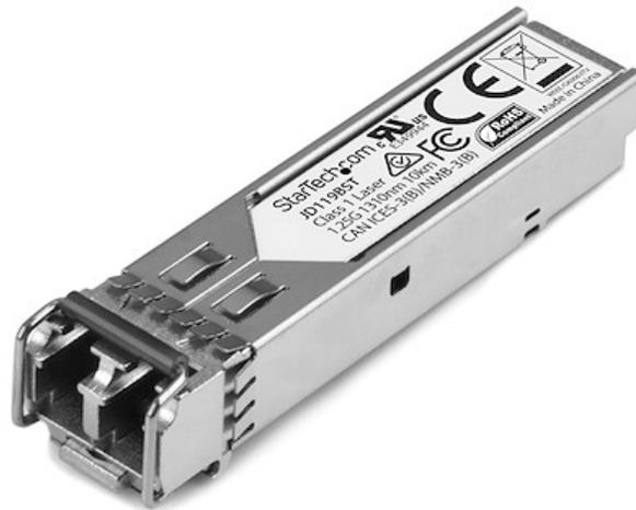
El modelo JD119BST es un módulo transceptor por fibra óptica, compatible con el modelo JD119B de HPE, diseñado, programado y probado para su funcionamiento con enrutadores y conmutadores de la marca HPE®. Ofrece conectividad fiable a 10GbE a través de cableado de fibra, para redes compatibles con 1000BASE-LX, a una distancia máxima de hasta 10km.
