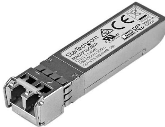
El modelo MASFP10GBSR es un módulo transceptor por fibra óptica compatible con el modelo MA-SFP-10GB-SR de Cisco Meraki, diseñado, programado y probado para su funcionamiento con enrutadores y conmutadores de la marca Cisco Meraki™. Ofrece conectividad 10GbE fiable a través de cable de fibra óptica para redes compatibles con 10GBASE-SR, con una distancia máxima de hasta 300m.
