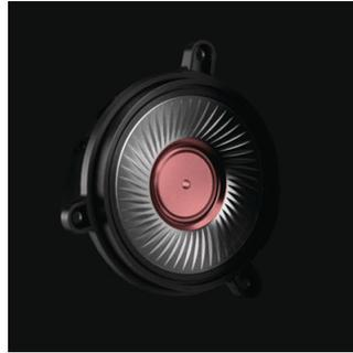
Mehrschichtig bewegungsgesteuerte Treiber verfügen über eine mehrschichtige Polymer-Membran, die ein dämpfendes Gel einschließt. Diese Schichten bilden eine flexible Grenze und absorbieren und dämpfen zusammen mit dem Gel zu hohe oder niedrige Frequenzen. Somit sorgen sie für einen ausgeglichenen und flacheren Frequenzgang. Das Ergebnis ist ein besonders ausgewogener, natürlicher und verbesserter Bereich an Hochfrequenzen.
