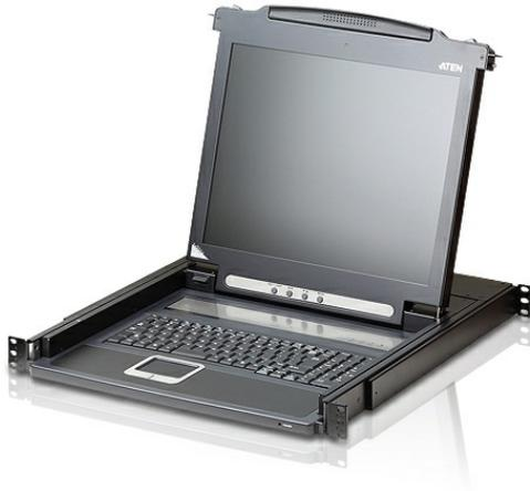
El CL1000 es una consola KVM LCD que realiza las funciones de interfaz de administración de numerosos switches KVM. El CL1000 incorpora un panel LCD con retroiluminación LED de 17" o 19" integrado, teclado completo y panel táctil en una carcasa de 1U, de montaje en bastidor y Slideaway™.
