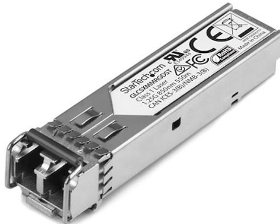
Das GLCSXMMRGDST ist ein Cisco GLC-SX-MM-RGD-kompatibles Glasfaser-Transceiver-Modul, das speziell für die Zusammenarbeit mit Cisco®-Switches und -Router entwickelt, programmiert und getestet wurde. Es liefert zuverlässige 1-GbE-Konnektivität über Glasfaserkabel für 1000BASE-SH-konforme Netzwerke mit einer maximalen Entfernung von bis zu 550 m.
