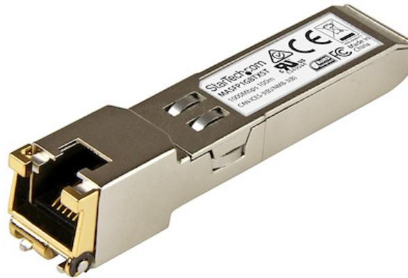
Das MASFP1GBSXST ist ein Cisco Meraki MA-SFP-1GB-SX-kompatibles Kupfer-Transceiver-Modul, das speziell für die Zusammenarbeit mit Cisco Meraki™-Switches und -Routern entwickelt, programmiert und getestet wurde. Es liefert zuverlässige 1-GbE-Konnektivität (1000 Mbit/s) über Kupferkabel für 10BASE-T-, 1000BASE-T- und 100BASE-TX-konforme Netzwerke mit einer maximalen Entfernung von bis zu 100 m.
