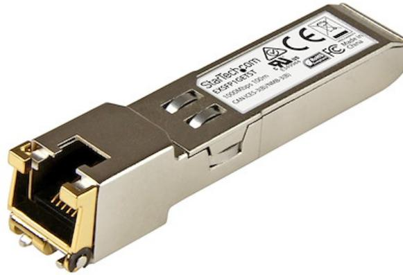
Das EXSFP1GETST ist ein Juniper EX-SFP-1GE-T-kompatibles Kupfer-Transceiver-Modul, das speziell für die Zusammenarbeit mit Juniper®-Switches und -Router entwickelt, programmiert und getestet wurde. Es liefert zuverlässige 1-GbE-Konnektivität über Kupferkabel für 10BASE-T-, 100BASE-TX- und 1000BASE-T-konforme Netzwerke mit einer maximalen Entfernung von bis zu 100 m.
