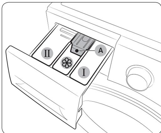
1. **I Vorwaschmittelfach:** In dieses Fach wird bei Bedarf Vorwaschmittel gefüllt.
