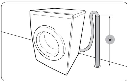
Schlauch in ein Abflussrohr einleiten
