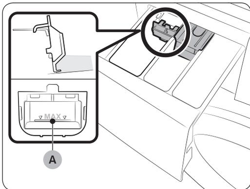
Setzen Sie zunächst den Flüssigwaschmitteleinsatz in das
