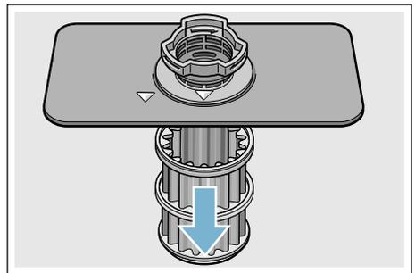
3. Eventuelle Reste entfernen und Siebe unter fließendem Wasser reinigen.
