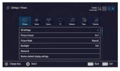
4 Select the required line »Picture Format«, »Picture Mode« or »Backlight« with »V« or »∧« and press »OK« to confirm. Select the option with »<« or »>«. Press »BACK ← « to return to »Picture« menu.
