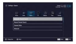
4 Select the line »Automatic Channel Search« with »V« or »∧« and press »OK« to confirm.
