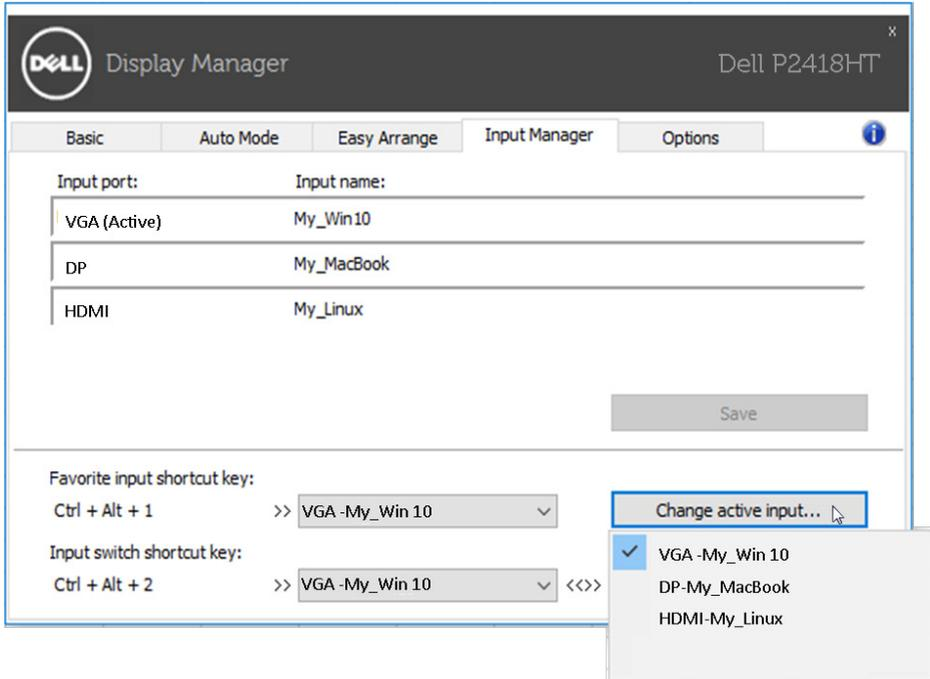
**HINWEIS:** DDM kommuniziert mit Ihrem Monitor, selbst wenn der Monitor Videobilder von einem anderen Computer anzeigt. Sie können DDM auf dem Computer, den Sie häufig verwenden, installieren und den Eingangswechsel darüber steuern. Zudem können Sie DDM auf anderen mit dem Monitor verbundenen PCs installieren.
