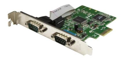
Esta tarjeta serie PCI Express agrega dos puertos serie RS232 de alto rendimiento a su servidor u ordenador de sobremesa, para la conexión de sus dispositivos y equipos basados en tecnología serie.
