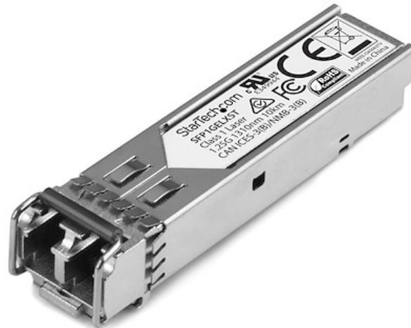
Das SFP1GELXST ist ein Juniper SFP-1GE-LX-kompatibles Glasfaser-Transceiver-Modul, das speziell für die Zusammenarbeit mit Juniper®-Switches und -Router entwickelt, programmiert und getestet wurde. Es liefert zuverlässige 1-GbE-Konnektivität über Glasfaserkabel für 1000BASE-LX-konforme Netzwerke mit einer maximalen Entfernung von bis zu 10 km.
