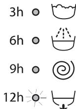
В течение на времето ще се визуализира оставащото забавяне чрез мигане на съответния светлинен индикатор:
