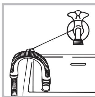
In alternativa, appoggiare il tubo di scarico al bordo di un lavandino o di una vasca, legando la guida (acquistabile presso il servizio assistenza) al rubinetto (vedi figura). L'estremità libera del tubo
