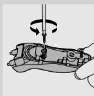
**6** Quite la cubierta de la unidad motora con un destornillador.
