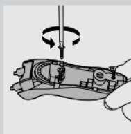
**6** Rimuovete il coperchio del gruppo di alimentazione con un giravite.
