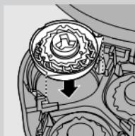
**3** Volte a colocar as cabeças na unidade de corte. Volte a colocar a armação de fixação na unidade de corte e rode o bloqueio para a direita.
