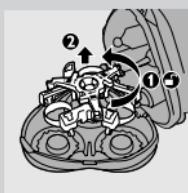
**1** Aprite l'unità di rasatura, ruotate il sistema di bloccaggio in senso antiorario (1) e rimuovete la struttura di supporto (2).
