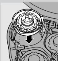
Asegúrese de que los salientes de los cabezales de afeitado encajan exactamente en las ranuras.
