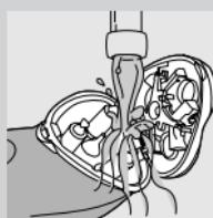
**3** Limpe a unidade de corte e a câmara de recolha dos pêlos à torneira com água quente durante algum tempo.
