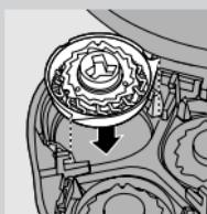
**3** Riposizionate le testine di rasatura nell'apposita unità. Reinserite la struttura di supporto nell'unità di rasatura e ruotate il sistema di bloccaggio in senso orario.
