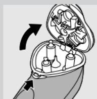
**1** Desligue a máquina de barbear, retire a ficha de alimentação da tomada eléctrica e puxe a ficha do aparelho para fora da máquina de barbear.
