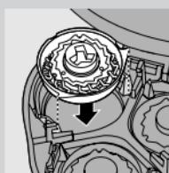
Assicuratevi che le sporgenze delle testine di rasatura si inseriscano perfettamente nelle rientranze.
