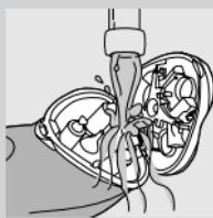
**3** Sciacquate l'unità di rasatura e la vaschetta dei peli sotto l'acqua calda corrente.
