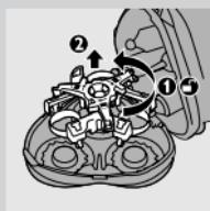
**1** Abra a unidade de corte, rode o bloqueio para a esquerda (1) e retire a armação de fixação (2).
