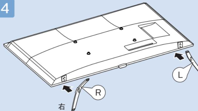
\*将底座按照图示对齐放置(注意区分左右支撑), R、L在底座上有标识。 7
