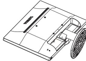
2. Pressione as patilhas de bloqueio para retirar a base da coluna de suporte.
