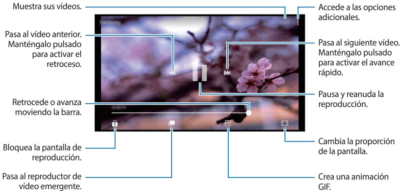
Para ajustar el brillo, deslice el dedo hacia arriba o hacia abajo en la parte izquierda de la pantalla de reproducción o deslízelo hacia arriba o hacia abajo en la parte derecha de la pantalla de reproducción para ajustar el volumen.
