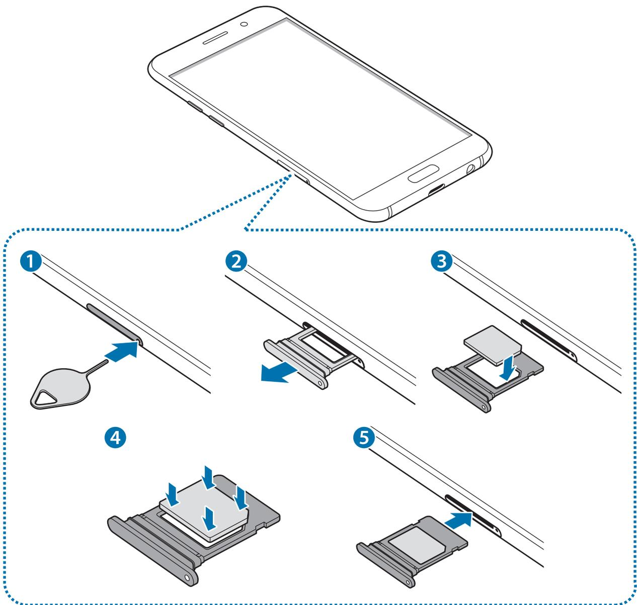
1 Para extraer la bandeja de la tarjeta SIM, inserte la anilla de extracción en el orificio de la bandeja.
