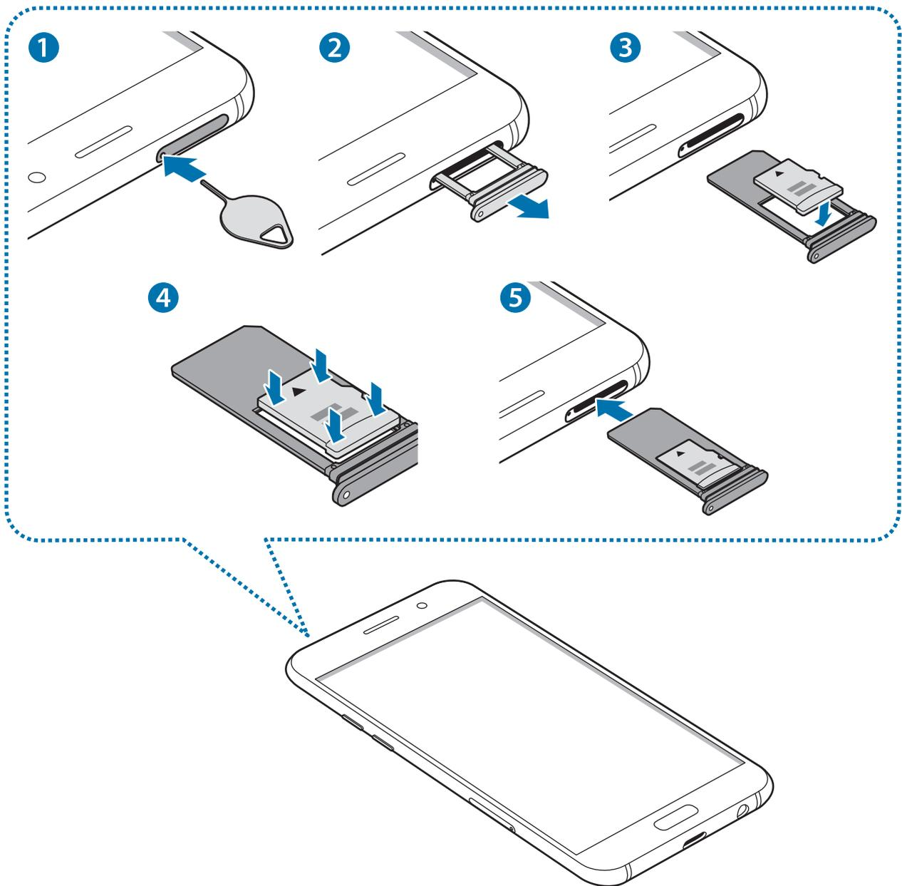
1 Para extraer la bandeja de la tarjeta de memoria, inserte la anilla de extracción en el orificio de la bandeja.
