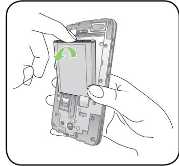
5. Rimuovete la Micro-SIM dallo slot Micro-SIM quindi riposizionate la batteria e la cover posteriore.
