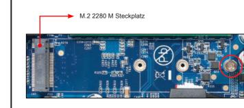
2. Installieren Sie die M.2-Karte in den M.2-Steckplatz und sichern Sie diese mit einer Schraube.
