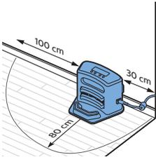
Nota: assegure-se de que não há obstáculos ou diferenças de altura a uma distância de 80 cm à frente, 30 cm para a direita e 100 cm para a esquerda da estação de base.
