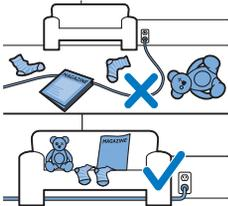
Antes de iniciar a limpeza com o robô, assegure-se de que remove todos os objectos soltos e frágeis do chão. Remova também todos os cabos e fios do chão.
