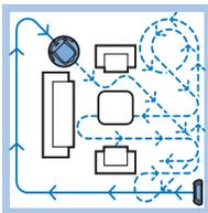
**4** Der Roboter reinigt im automatischen Reinigungsmodus, bis der Akku fast leer ist. Im automatischen Reinigungsmodus wird eine bestimmte Muster-Abfolge wiederholt: Z-Muster, zufälliges Muster, den Wänden entlang und Spiralmuster.
