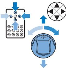
1 Bruk av piltastene over og under og til høyre og venstre for start/stopp-knappen på fjernkontrollen for å styre roboten rundt i rommet.
