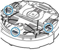
Roboten har tre fallsensorer på undersiden. Den bruker disse fallsensorene til å registrere og unngå høydeforskjeller (f.eks. trapper).
