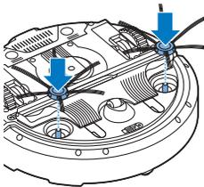
Obs! Var noga med att montera borstarna på rätt sätt. Tryck fast dem på axlarna till dess att de låses på plats med ett klickljud.
