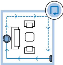
Neste modo, o robot segue as paredes da divisão para assegurar uma limpeza extra das áreas junto às paredes.
