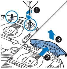
3 Desenrosque los tornillos y quite la tapa del compartimento de la batería.
