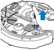
1 Para sustituir los cepillos laterales, sujete los cepillos laterales usados por las cerdas y tire para extraerlos de sus ejes.
