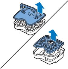
4 Tøm støvbeholderen ved å riste den over en søppelbøtte. Rengjør filteret og innsiden av støvbeholderen med en klut eller en tannbørste med myk bust. Rengjør også sugeåpningen på undersiden av støvbeholderen.
