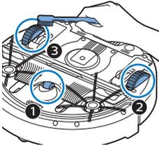
3 Verwenden Sie eine Bürste mit weichen Borsten (z. B. eine Zahnbürste), um Staub oder Fussel vom Vorderrad und den Seitenrädern zu entfernen.
