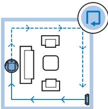
In diesem Modus folgt der Roboter dem Verlauf der Wände, um den Bereich an den Wänden zusätzlich zu reinigen.
