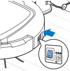
**3** De start/stop-knop begint te knipperen. Wanneer u de robot oplaadt, is de oplaadindicator gedurende de eerste 3 minuten zichtbaar op het display.
