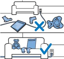
Bevor Sie mit dem Roboter die Reinigung starten, sollten Sie sich vergewissern, dass sich keine losen und zerbrechlichen Gegenstände auf dem Boden befinden. Bringen Sie auch alle Kabel, Drähte und Schnüre in Sicherheit.
