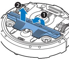
**7** Ouvrez les fermoirs de la brosse TriActive XL en posant vos doigts aux emplacements marqués d'une flèche, puis en retirant la brosse TriActive XL du robot.
