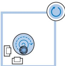
In diesem Modus bewegt sich der Roboter in einem spiralförmigen Muster, um einen kleinen verschmutzten Bereich gründlich zu reinigen. Im Spiralmodus wird der Lüfter mit maximaler Drehzahl betrieben.
