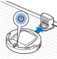
**5** Når batteriet begynder at blive afladet, bliver start/stop-knappen orange, og robotten søger tilbage til dockingstationen for at blive ladet op.
