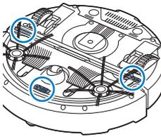
Der Roboter hat drei Stopp-Sensoren an der Unterseite. Er verwendet diese Stopp-Sensoren, um Höhenunterschiede, wie z. B. Stufen, zu erkennen und zu vermeiden.
