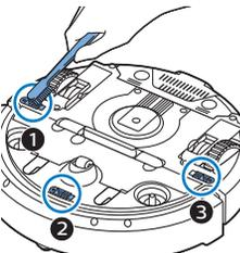
Nota: é importante limpar os sensores de queda regularmente. Se os sensores de queda estiverem sujos, o robot pode não conseguir detetar diferenças de altura ou escadas.
