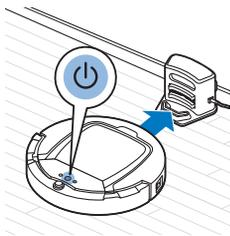
**5** Quando la batteria è quasi scarica, il pulsante di avvio/arresto diventa arancione e il robot inizia a cercare la docking station per ricaricarsi.
