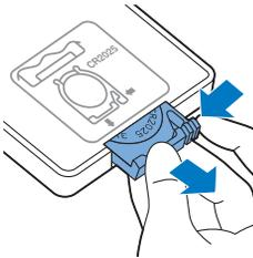
2 Retire la pila descargada del soporte y coloque una nueva. Vuelva a deslizar el soporte de la pila en el mando a distancia.
