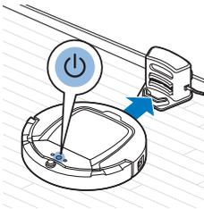
1 Når roboten er ferdig med å rengjøre, eller når det kun gjenstår 15 % batterikapasitet, søker den automatisk etter dokkingstasjonen for å lade opp. Når roboten søker etter dokkingstasjonen, blir lyset i start/stopp-knappen oransje.
