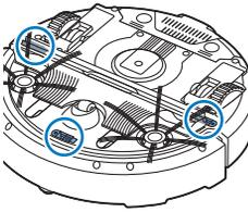
Il robot dispone di tre sensori per il rilevamento del vuoto nella parte inferiore. Questi sensori sono utilizzati per rilevare ed evitare i dislivelli, come ad esempio le scale.
