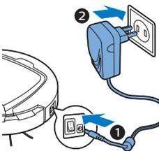
Merke: Etter ladingen tar du den lille pluggen ut av kontakten på roboten, og tar adapteren ut av stikkontakten. Roboten vil ikke starte rengjøring så lenge den er koblet til en stikkontakt.
