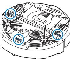
O robot possui três sensores de queda na parte inferior. Ele utiliza estes sensores de queda para detetar e evitar diferenças de altura, como escadarias.
