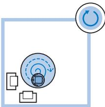
Neste modo, o robot move-se em espiral numa área pequena para a limpar em profundidade. No modo em espiral, a ventoinha funciona em velocidade turbo.
