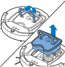
Merk: Når du fjerner eller setter inn støvbeholderen, må du passe på at du ikke skader bladene på viften.
