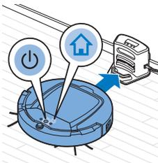
**7** For at få robotten til at vende tilbage til dockingstationen, inden det genopladelige batteri når et lavt niveau, skal du trykke på dockingknappen på fjernbetjeningen (kun FC8932). Dockingindikatoren på robotens display tændes, og robotten vender tilbage til dockingstationen.
