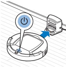
**5** När batteriet börjar ta slut blir start/stopp-knappen orange och roboten återvänder till dockningsstationen för att laddas.
