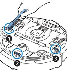
Nota: Es importante limpiar los sensores de interrupción regularmente. Si los sensores de interrupción están sucios, el robot puede fallar al detectar las diferencias de altura o las escaleras.
