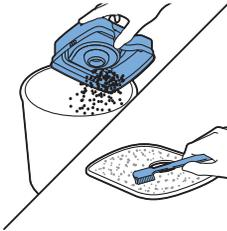
4 Skaka dammbehållaren över en soptunna för att tömma den. Rengör filtret och insidan av dammbehållaren med en trasa eller en mjuk tandborste. Rengör även sugöppningen på undersidan av dammbehållaren.
