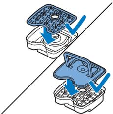
5 Laita suodatin takaisin pölysäiliöön ja kansi pölysäiliön päälle.
