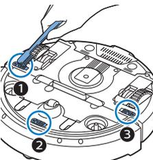
Nota: è importante che i sensori di rilevamento del vuoto siano puliti regolarmente. Quando i sensori sono sporchi, il robot potrebbe non rilevare scale o dislivelli.
