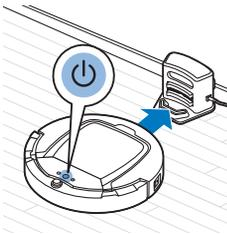
**5** Wenn der Akku fast leer ist, wechselt die Start-/Stopp-Taste zu Orange, und der Roboter sucht zum Aufladen die Docking-Station.
