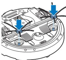
Nota: assegure-se de que encaixa as escovas laterais corretamente. Pressione-as sobre o eixo até as ouvir encaixar na posição correta com um estalido.
