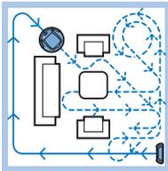
**4** De robot maakt schoon in de modus Automatisch reinigen tot de accu leeg begint te raken. In de modus Automatisch reinigen volgt de robot herhaalde reeksen van patronen in deze volgorde: Z-patroon, willekeurig patroon, muurvolgend patroon en spiraalpatroon.
