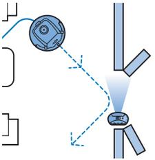
Merk: Ved bruk av den usynlige veggen må du sjekke med jevne mellomrom at batteriene er tilstrekkelig oppladet. Du kan gjøre dette ved å slå den virtuelle veggen på og av. Hvis batteriene er tilstrekkelig oppladet, vil LED-lampen på den usynlige veggen lyse kort.
