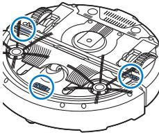
De robot heeft drie valsensoren aan de onderkant. De robot gebruikt deze valsensoren om hoogteverschillen, zoals een trap, te detecteren en te vermijden.
