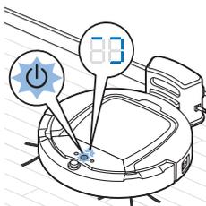
**4** Quando la batteria è completamente carica, il pulsante di avvio/arresto si accende a luce fissa.
