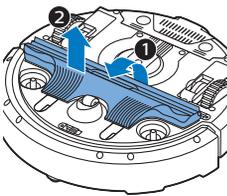
7 Öffnen Sie die Schnappverschlüsse der TriActive XL-Düse. Halten Sie sie dazu an den mit Pfeilen markierten Stellen, und ziehen Sie die TriActive-Düse vom Roboter ab.
