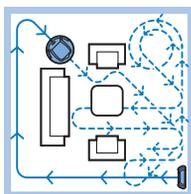
**4** Il robot pulisce in modalità di pulizia automatica finché la batteria non si scarica. In modalità di pulizia automatica, il robot segue sequenze ripetute di movimenti a zig-zag, movimenti casuali, movimenti che seguono i contorni del muro e movimenti a spirale.
