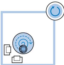
In questa modalità, il robot effettua movimenti a spirale per pulire a fondo una piccola area sporca. In modalità a spirale, la ventola funziona a velocità turbo.
