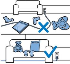
Før du lar roboten rengjøre, må du sørge for at du fjerner alle løse og skjøre gjenstander fra gulvet. Fjern også alle kabler og ledninger fra gulvet.
