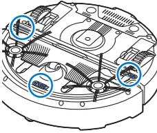
El robot está equipado con tres sensores de interrupción en la parte inferior. Estos sensores de interrupción se utilizan para detectar y evitar las diferencias de altura, por ejemplo, unas escaleras.
