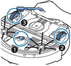
**3** Utilisez une brosse à poils souples (par exemple une brosse à dents) pour éliminer la poussière ou les peluches de la roue avant et des roues latérales.
