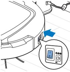
2 Käynnistä robotti painamalla virtakytkintä.
