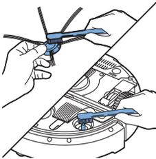
5 Entfernen Sie mit einer weichen Bürste (z. B. einer Zahnbürste) oder einem Tuch Fusseln, Haare und Fäden vom Schaft und von der Seitenbürste.
