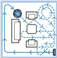
**4** Robotten rengør i auto-rengøringstilstand, indtil batteriets kapacitet bliver lav. I auto-rengøringstilstand følger den gentagne sekvenser med Z-mønster og tilfældige bevægelser, væg-følgende bevægelser og spiralformede mønstre.
