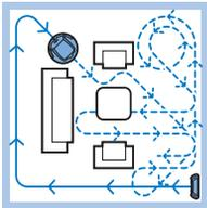
**4** Roboten rengör i läget för automatisk rengöring tills batteriet börjar ta slut. I det automatiska rengöringsläget följer roboten upprepade sekvenser av Z-mönster, slumpmässiga mönster, väggföljande mönster och spiralmönster.
