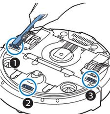
Opmerking: Het is belangrijk om de valsensoren regelmatig te reinigen. Als de valsensoren namelijk vuil zijn, kan de robot mogelijk geen hoogteverschil of trap meer detecteren.
