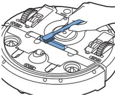
8 Reinigen Sie die Ansaugöffnung mit einer weichen Bürste (z. B. einer Zahnbürste).
