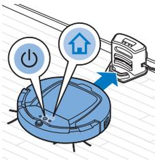
**7** Wenn der Roboter zur Docking-Station zurückkehren soll, bevor der Akku zur Neige geht, drücken Sie die Docking-Taste auf der Fernbedienung (nur FC8932). Die Docking-Anzeige auf dem Display des Roboters schaltet sich ein, und der Roboter kehrt zur Docking-Station zurück.
