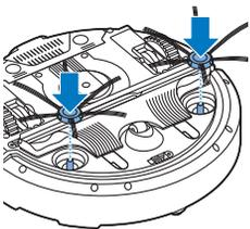
**11** Skyv sidebørstene på nytt på akslene på undersiden roboten.
