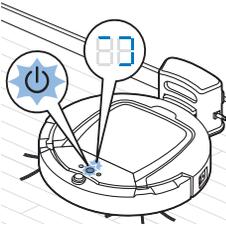
4 Cuando la batería recargable está completamente cargada, el botón de inicio/parada se ilumina de forma continua.
