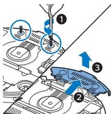
3 Allentate le viti del coperchio del vano batterie e rimuovetelo.
