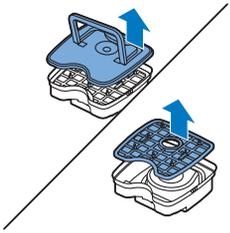
3 Irrota varovasti pölysäiliön kansi ja poista suodatin.
