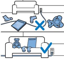
Ennen kuin käynnistät robotin imurointikierroksen, poista kaikki irralliset ja särkyvät esineet lattialta. Poista myös kaikki kaapelit ja johdot lattialta.
