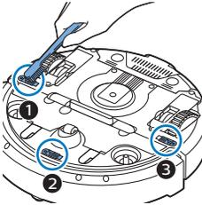
Merk: Det er viktig at du rengjør fallsensorene regelmessig. Hvis fallsensorene er skitne, kan det hende at roboten ikke klarer å registrere høydeforskjeller eller trapper.
