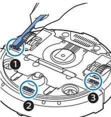
Remarque : Il est important de nettoyer les capteurs de chute régulièrement. Si les capteurs de chute sont sales, il se peut que le robot ne détecte pas les différences de hauteur ou les escaliers.
