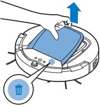
2 Trekk opp håndtaket på støvbeholderlokket, og løft støvbeholderen ut av støvbeholderkammeret.
