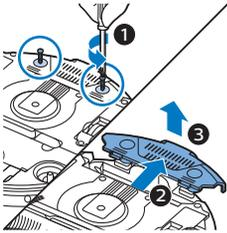
3 Lösen Sie die Schrauben an der Akkufachabdeckung, und entfernen Sie die Abdeckung.
