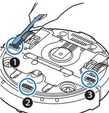
Bemærk: Det er vigtigt at rengøre sensorerne regelmæssigt. Hvis sensorerne er tilsmudsede, kan robotten ikke registrere højdeforskelle eller trapper.
