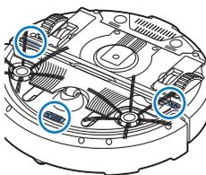
Le dessous du robot est équipé de trois capteurs de chute. Il utilise ces capteurs de chute pour détecter et éviter les différences de hauteur telles que les escaliers.
