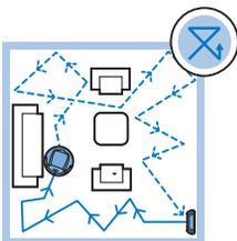
In diesem Modus reinigt der Roboter den Raum mit einem gemischten Muster aus geraden und zickzackförmigen Bewegungen.
