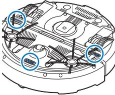
Robotten har tre sensorer i bunden. Disse sensorer bruges til at registrere og undgå højdeforskelle, som f.eks. trapper.
