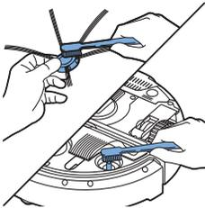
**5** Retirez les peluches, les poils et les fils de l'axe et de la brosette latérale avec une brosse douce (par exemple une brosse à dents) ou un chiffon.
