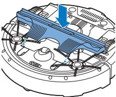
**10** Sett låsekroene på TriActive-munnstykket inn i hullene på undersiden av roboten. Trykk TriActive-munnstykket tilbake i posisjon. Kontroller at munnstykket kan beveges fritt opp og ned noen millimeter.
