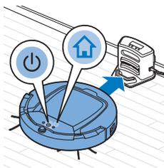
**7** Para o robot regressar à estação de base antes de a bateria recarregável ficar com pouca carga, prima o botão da base no telecomando (apenas FC8932). O indicador da base no visor do robot acende-se e o robot regressa à estação de base.
