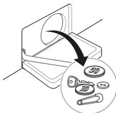
4 Dopo la pulizia, ruotare il filtro della pompa e inserire il tappo di scarico.
