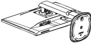
3. Afloje los tornillos de ensamblaje y, a continuación, desmonte el cuello del monitor.
