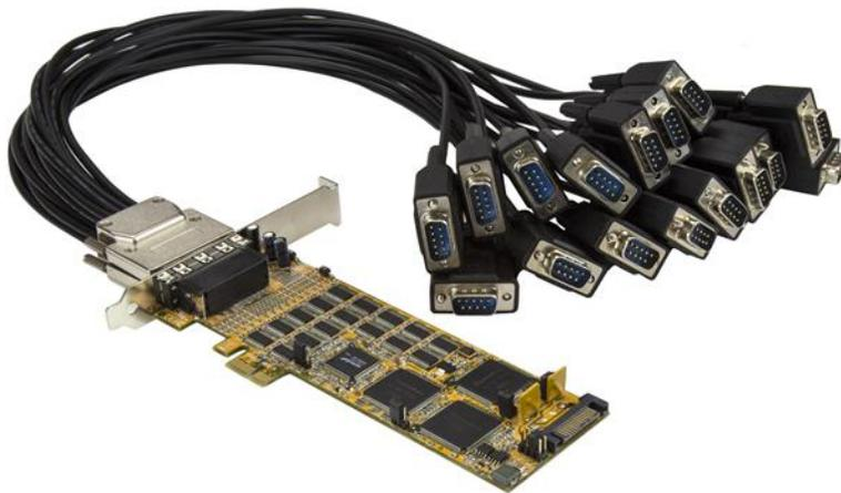
Questa scheda PCI Express seriale permette di aggiungere 16 porte RS232 ad alta velocità a un server o computer desktop a profilo standard o a basso profilo. Ciò consente di massimizzare il numero di porte RS232 DB9 disponibili per collegare le apparecchiature e i dispositivi seriali, utilizzando solo un singolo slot PCI Express (PCIe). È la soluzione perfetta per aggiungere le porte seriali necessarie, anche se il server o computer desktop ha solo un numero limitato di slot di espansione PCIe.
