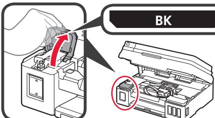
**2** Tartu kiinni mustesäiliön säiliön korkkiin, irrota se ja aseta se ylempään säiliön korkin pidikkeeseen.
