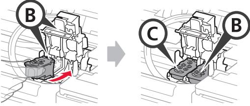
**6** Sluit het sluitklepje van de cartridge en druk het omlaag.
