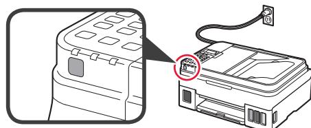
Hvis det vises en feilmelding, kontrollerer du at kassettene er riktig installert.
