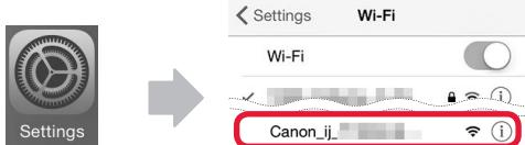
Als **Canon\_ij\_XXXX** niet wordt weergegeven in de lijst, raadpleegt u 'De printer voorbereiden' hieronder om de printer te bedienen en herhaalt u stap 1.
