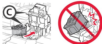
**5** Gjenta trinn 2 til 4 for å sette inn kassetten B (svart) til høyre.
