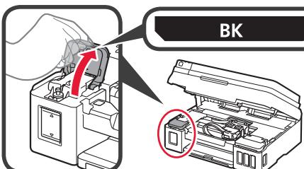
**2** Ta bort behållarlocket på bläckbehållaren och lägg locket på den övre hållaren för behållarlock.
