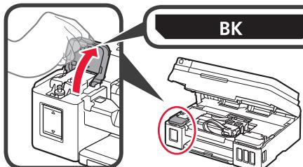
**2** Afferrare e rimuovere il coperchietto del serbatoio del serbatoio d'inchiostro, quindi posizionarlo sul supporto coperchietto del serbatoio superiore.
