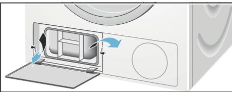
11. Schließen Sie die Wartungsklappe bis diese fühlbar einrastet.
