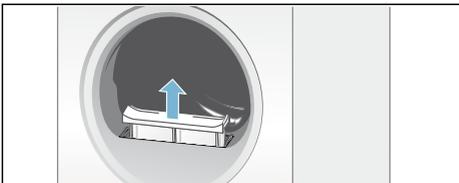
3. Entfernen Sie die Flusen aus der Mulde des Flusensiebes.
