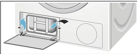
4. Ziehen Sie den Ausatz des Wärmetauschers heraus.
