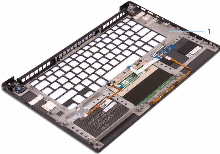
**Abbildung 37. Entfernen der Handballenstütze**
