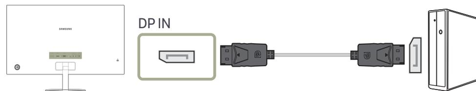
— Il est recommandé d'utiliser un câble DP d'une longueur inférieure à 1,5 m. L'utilisation d'un câble d'une longueur supérieure à 1,5 m peut affecter la qualité de l'image.
