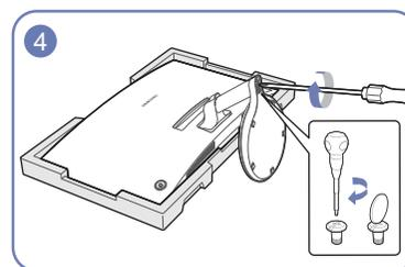
Fixez la base du socle au col du socle puis attachez les deux vis à la base pour la fixer solidement.
