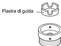
3 Spingere l'adattatore sull'estremità del rubinetto in modo che la guarnizione in gomma formi un collegamento stagno. Stringere le quattro viti di fissaggio.
