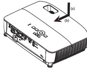
10. Ziehen Sie die Schraube an, mit der die Lampenabdeckung befestigt wird.
