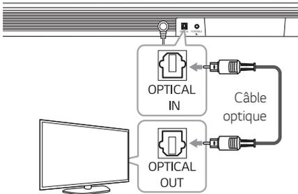
2. Appuyez plusieurs fois sur la touche **F** de la télécommande ou de l'appareil jusqu'à ce que la source d'entrée optique OPTICAL soit sélectionnée.
