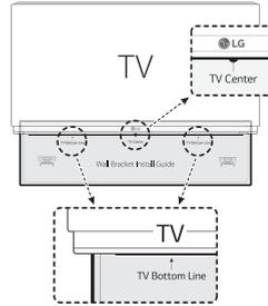
2. Si vous fixez la barre de son sur un mur en béton, utilisez des chevilles. Vous devrez percer quelques trous. Un gabarit (Guide d'installation des supports muraux) est fourni pour vous y aider. Utilisez-le pour repérer les endroits où vous devez percer.
