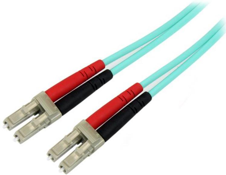
Ce câble à fibre optique vous permet de connecter des transceivers 40GBase-SR4, 100GBase-SR10, SFP+ et QSFP+ à des réseaux 40 et 100 Gigabit. Le câble OM4 prend en charge les sources de lumière laser à cavité verticale à émission par la surface (VCSEL) et LED. Il est rétrocompatible avec votre équipement 50/125 existant.
