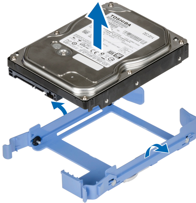
Figura 26. Extracción de una unidad de disco duro de un portaunidades de disco duro
